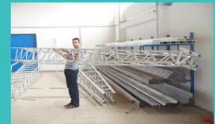
STUB OD AL-LEGURE DUŽINE 8,4m I TEŽINE MANJE OD 23kg
