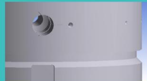
MIJESTO UVODA POBUĐNE STRUJE U GENERATOR - ZONA POJAVE PRSLINA
