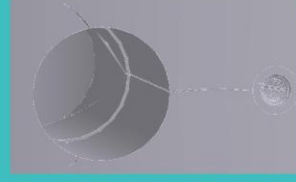
MIJESTO UVODA POBUĐNE STRUJE U GENERATOR - ZONA POJAVE PRSLINA
