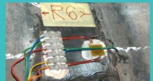
MJERNO MJESTO 6-METODA EKSTENZOMETRIJE
