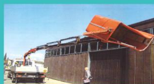
ISPITIVANJE DIZALICE FASSI F65.A24 SA DEFORMISANOM KORPOM
